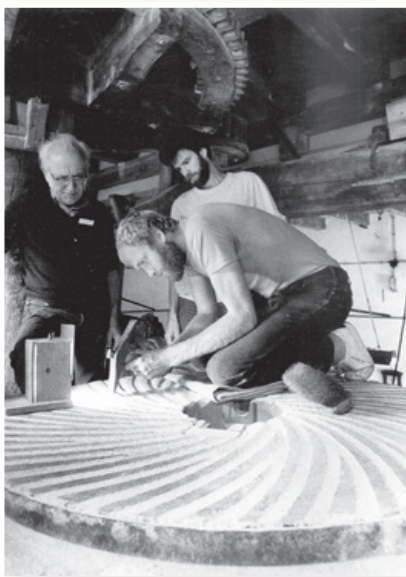
De molensteen wordt gebild. Molenaar Piet van Silfhout houdt een oogje in het zeil, 1983.
