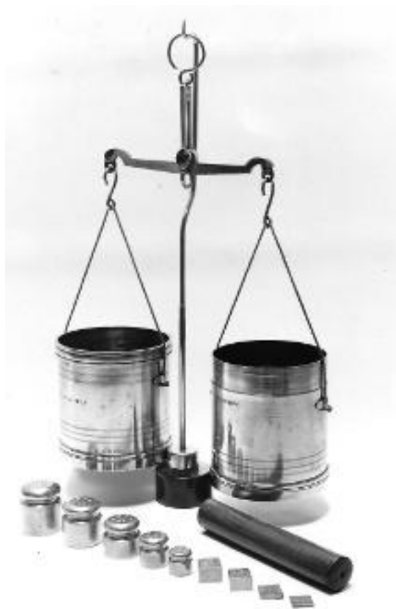
De graanbalans ('korenschaal') van Van Heeckeren uit 1839, bestaande uit: de maatschaal (roodkoperen bovenrand), de gewichtenschaal, het balansjuk, de balanshaken, de (negen) gewichten en de strijksok.
